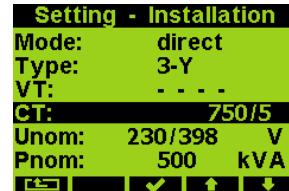
Teraz możesz wpisać nową wartość parametru CT: przyciskiem ▶, można przejść od kolejnej cyfry i każdą z cyfr ustawić do wartości docelowej za pomocą ▲ i ▼. Na koniec naciśnij przycisk ✓ i parametr jest ustawiony. Można ustawić inne parametry w ten sam sposób.
